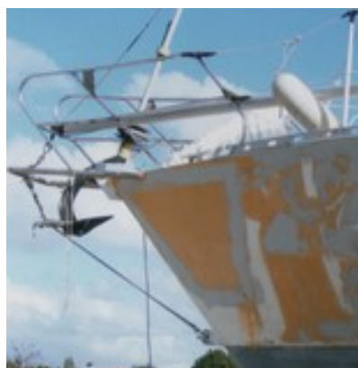
... soudure de nouvelles tôles...
